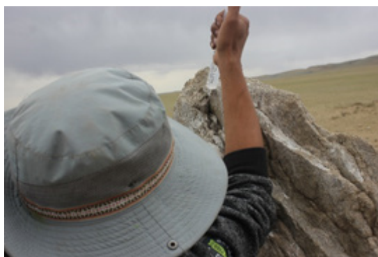
Зураг 23, 24: Ус+этилийн спирт болон дан этилийн спиртийг ашиглан чулууны ан цав, цуурлыг шалгаж байгаа нь
